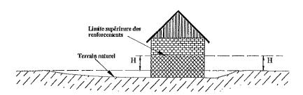
En cas de terrassements en déblais, la hauteur doit être mesurée par rapport au terrain naturel initial.
